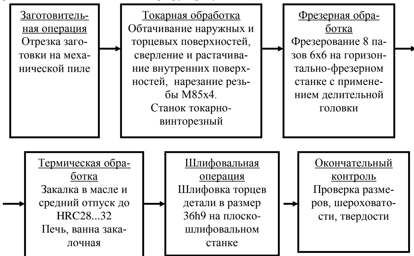
Рисунок В3. Технологический маршрут изготовления детали «Гайка»
