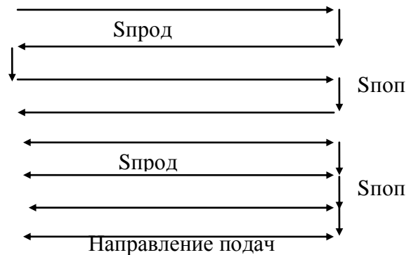
Рисунок 1. Круглое наружное шлифование с продольной подачей
