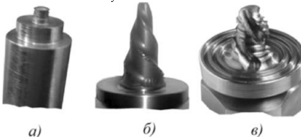
Рисунок 8.6 Рабочие части инструментов используемых при ПСТ: а – традиционная конструкция инструмента; б – инструмент для получения глубоких швов; в – инструмент со специальной формой торца. Показан намазанный на выступ свариваемый металл.
