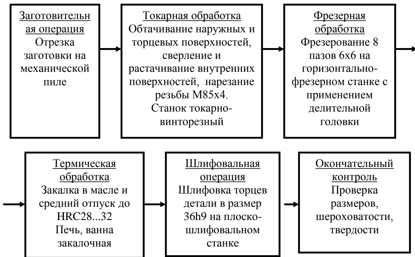
Рисунок В2. Технологический маршрут изготовления детали «Гайка»
