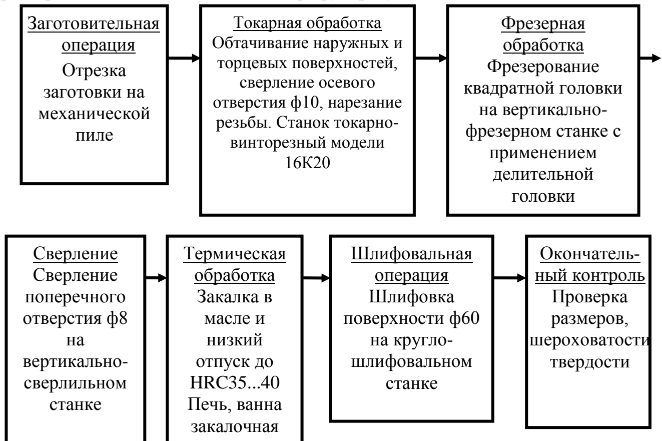
Рисунок Б2 Технологический маршрут изготовления детали «Опорная ось»
