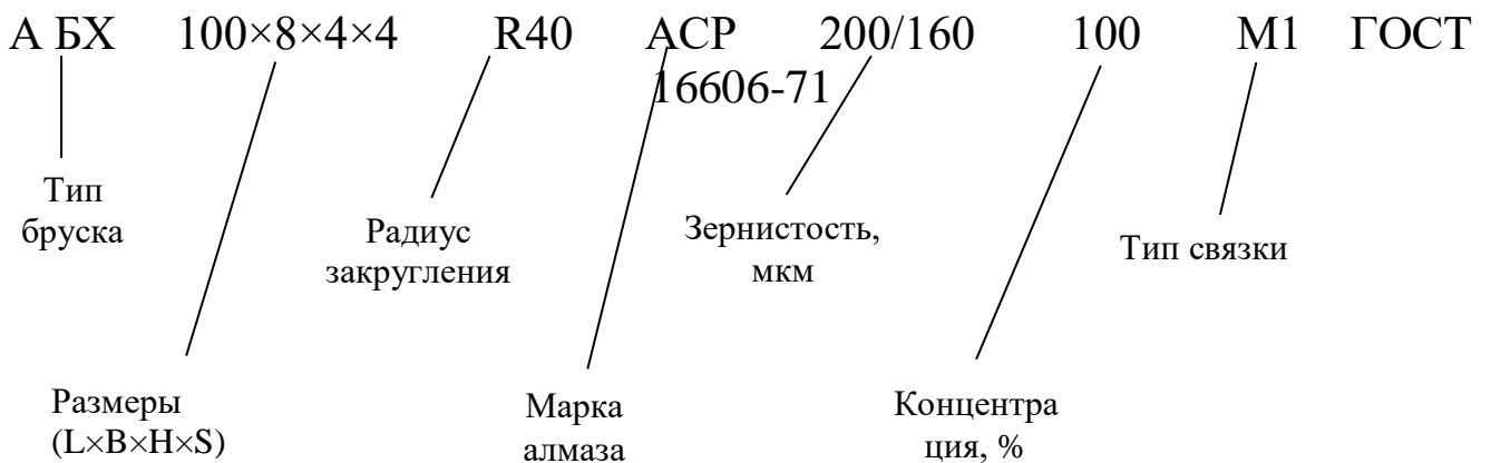
Рисунок 1 Пример обозначения алмазных хонинговальных брусков
