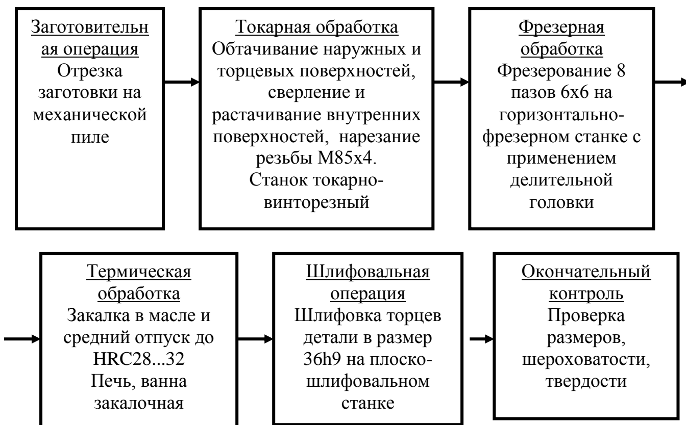
Рисунок В2. Технологический маршрут изготовления детали «Гайка»
