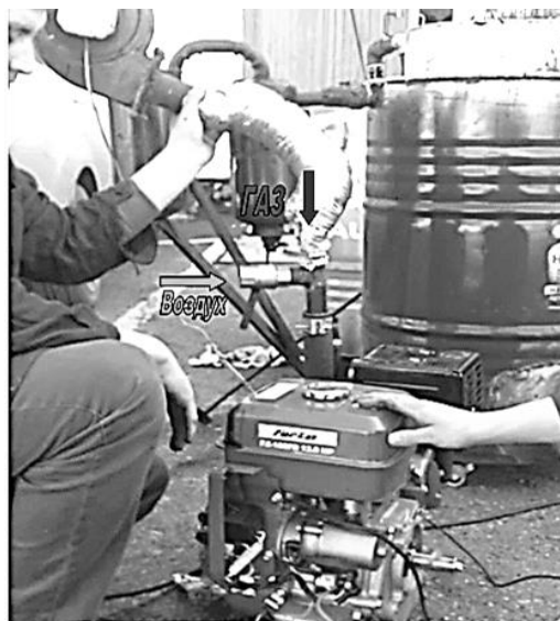
Рисунок 4 Подача генераторного газа в ДВС
