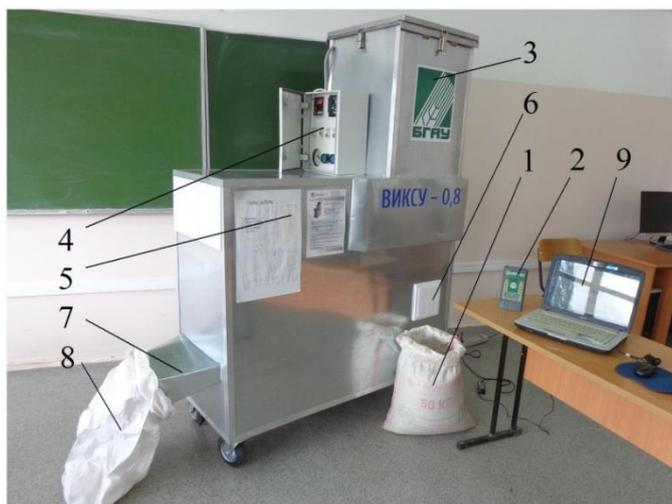
1 – исходное зерно; 2 – влагомер зерна; 3 – сушильная камера, оборудованная инфракрасными излучателями; 4 – блок управления; 5 – корпус установки; 6 – вентилятор; 7 – выгрузное устройство; 8 – высушенное зерно; 9 – персональный компьютер для обработки данных.
