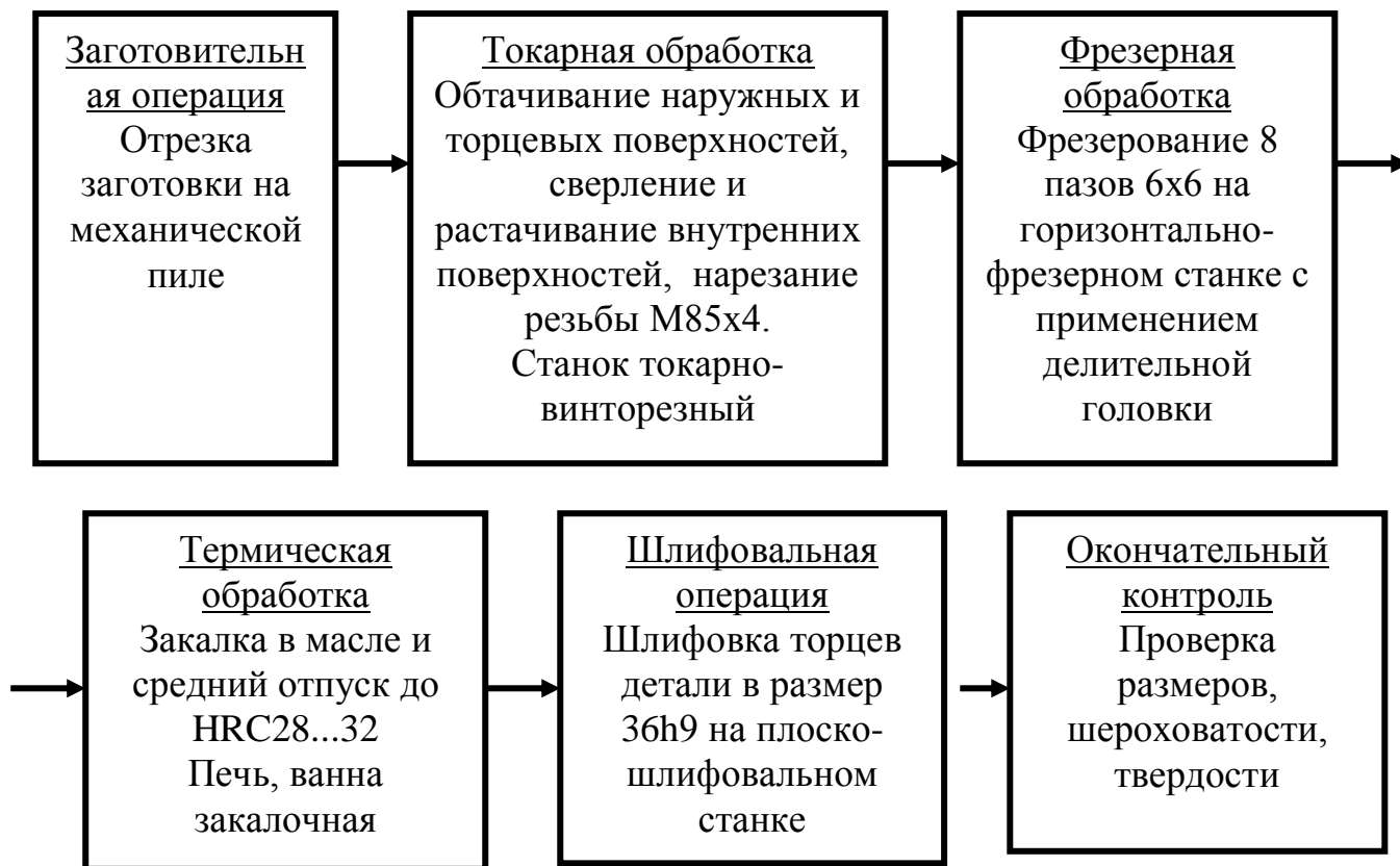
Рисунок В2. Технологический маршрут изготовления детали «Гайка»
