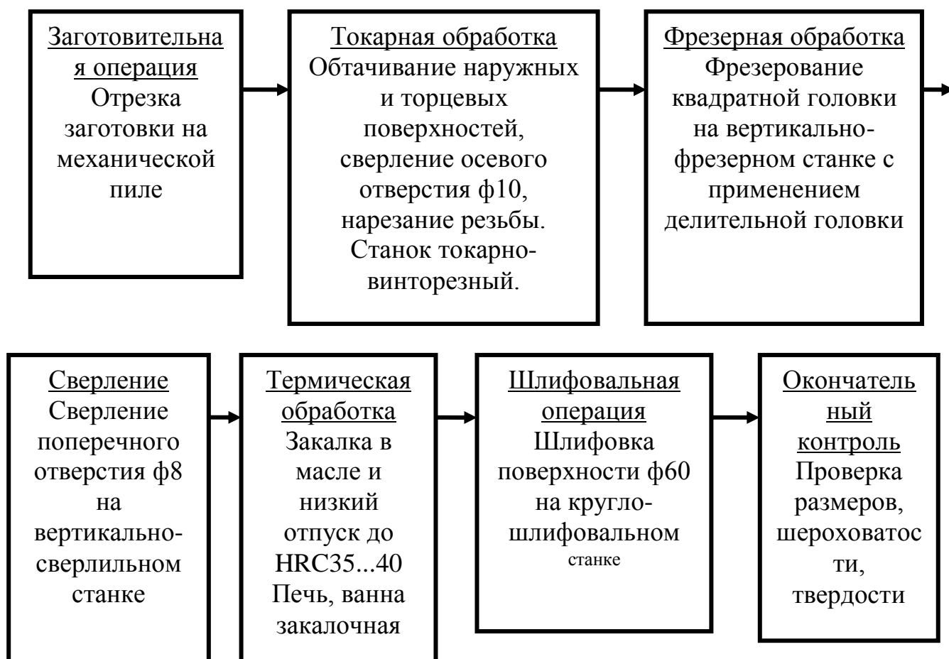
Рисунок Б3 Технологический маршрут изготовления детали «Опорная ось»
