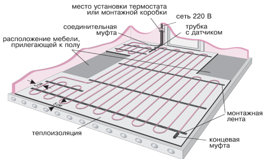
Рисунок 3.3 Система электрообогрева после монтажа
