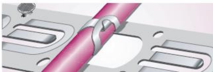
Рисунок 3.1 Закрепление кабеля на монтажной ленте
