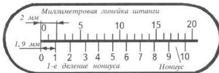
Рисунок 3.7 Шкала штанги и нониус штангенинструментов
