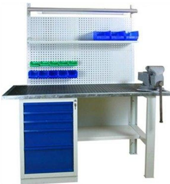
Рисунок 1.3 Слесарный верстак с поворотными тисками
