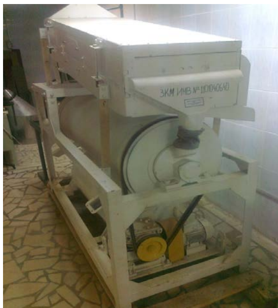
Рисунок 5.3 Зерноочистительная комбинированная машина ЗКМ-1,5
