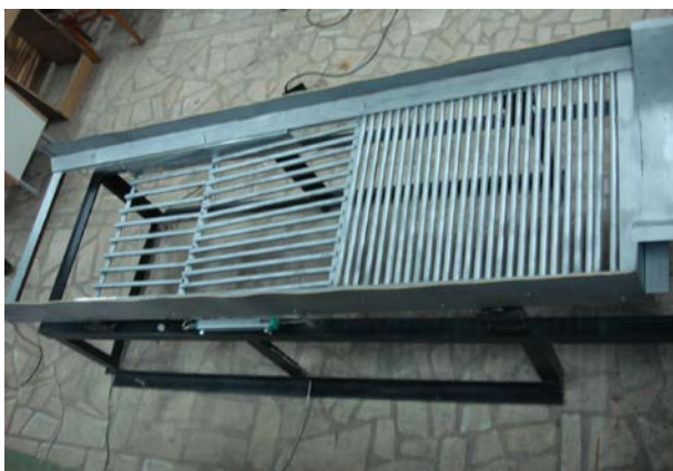
Рисунок 4.15 Экспериментальная установка для исследования ЛАЭСКД инерционной картофелесортировальной машины
