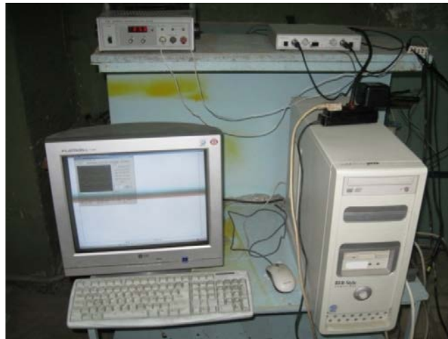
Рисунок 4.26 Рабочее место с АЦП Velleman PCS64i и ПК
