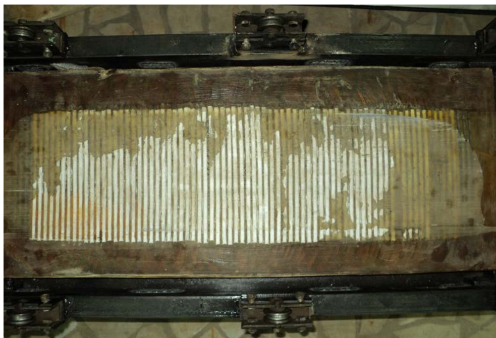
Рисунок 4.16 Индуктор плоского одностороннего ЛАД, залитый компаундом
