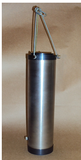
а-утяжелённый, с трубой из нержавеющей стали
