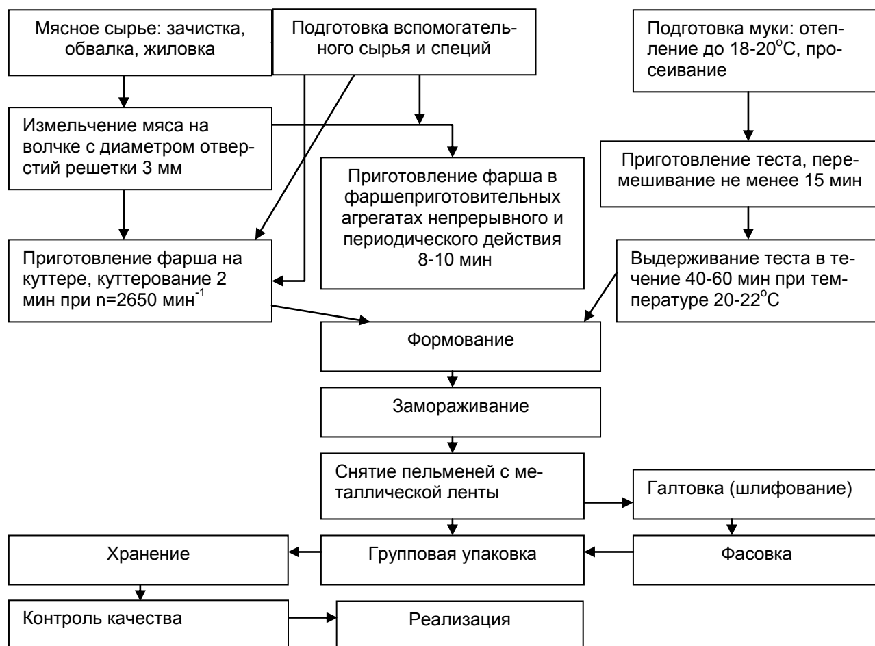
Рисунок 5 Технологическая схема производствапельменей
