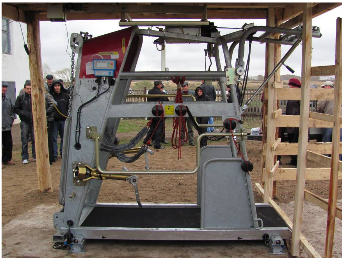
Рисунок 17 Станок для обработки копыт импортного производства
