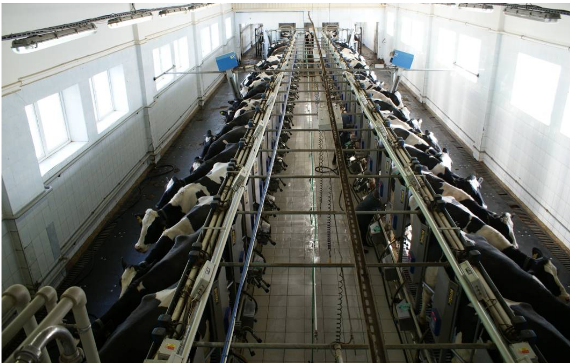
Рисунок 16. Доильный зал елочка 2x20 с быстрым выходом «Farmtec» (Агрофирма «Байрамгул» Учалинского района)
