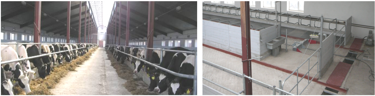
Рисунок 6. Внутренняя планировка коровника с беспривязно-боксовым содержанием (ГУСП совхоз Алексеевский)
