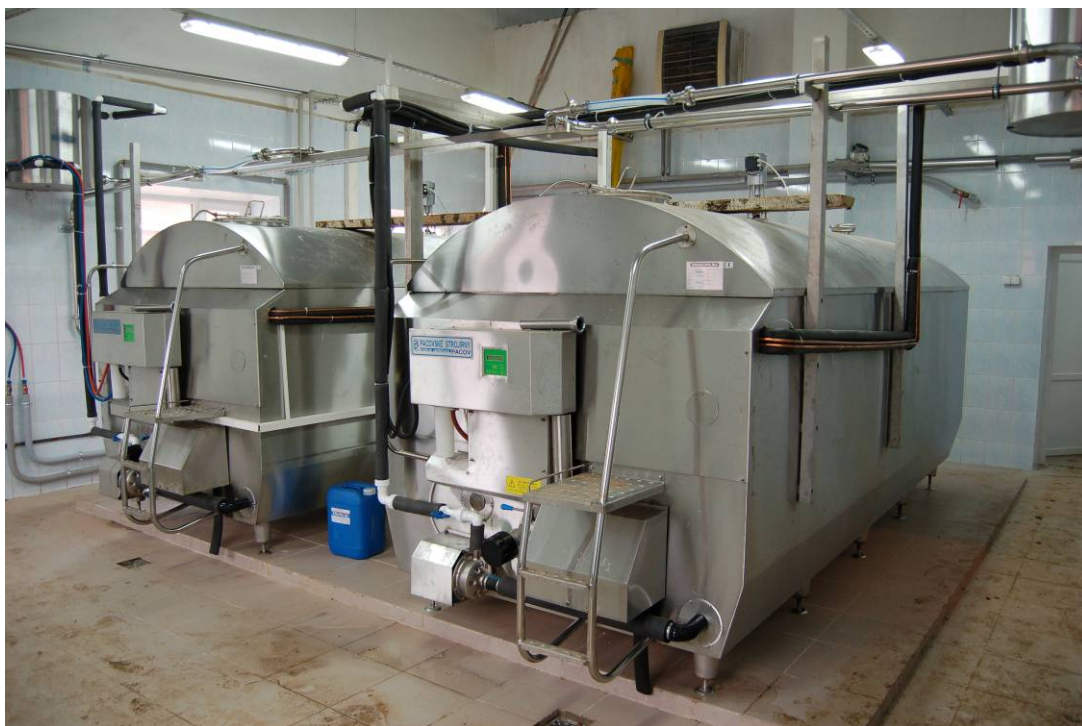
Рисунок 20. Танк-охладитель с намораживанием льда (ГУСП совхоз Алексеевский)
