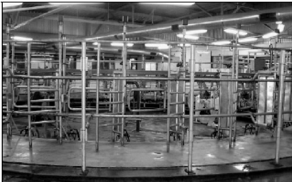
Рисунок 18. Доильная установка «Карусель» «Westfalia Surge» (КФХ Алатау Кармаскалинского района)
