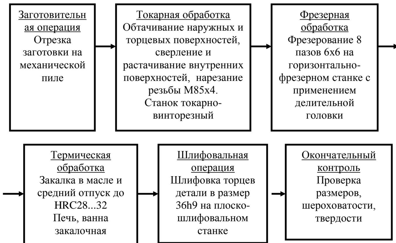
Рисунок В2. Технологический маршрут изготовления детали «Гайка»
