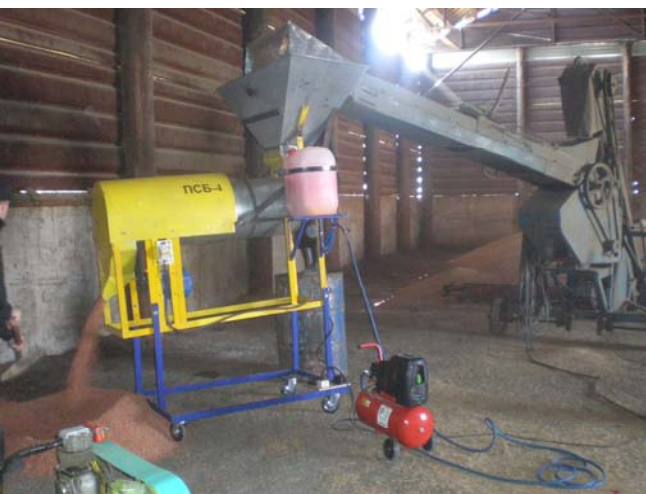
Рисунок 1.25 Протравливатель семян барабанный ПСБ-4 и ПСБ-10 на производственных испытаниях в 2008 и 2009 г.г.
