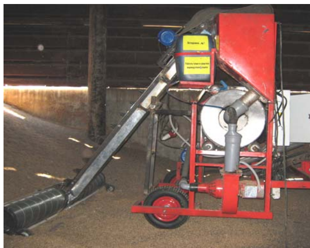
Рисунок 1.25 Протравливатель семян барабанный ПСБ-4 и ПСБ-10 на производственных испытаниях в 2008 и 2009 г.г.
