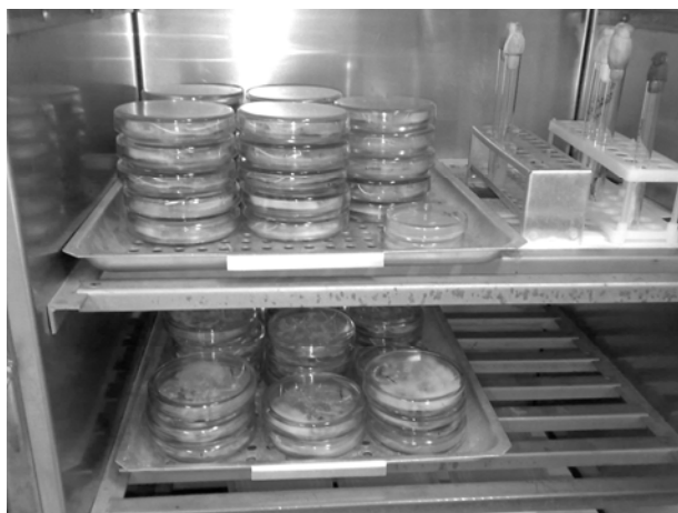
Рисунок 4.4 Инкубирование чашек в термостате
