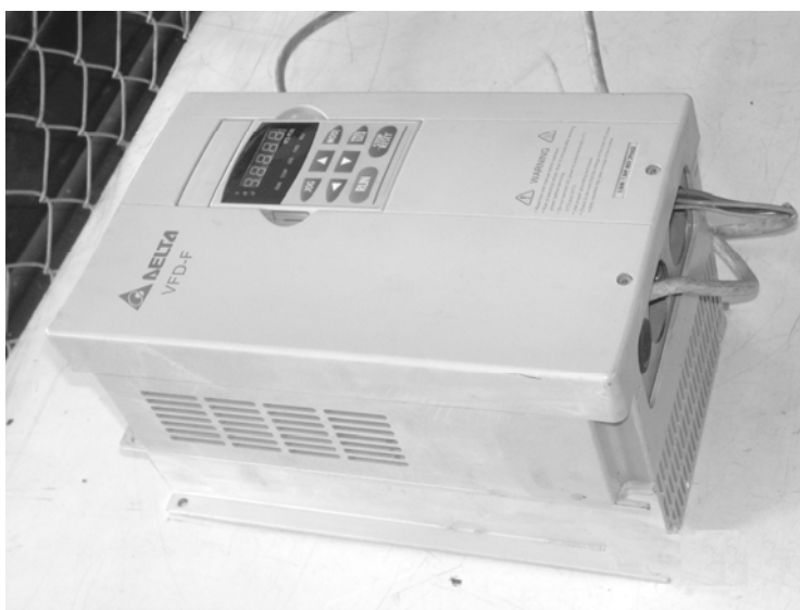
Рисунок 4.18 Частотный преобразователь VFD055F43B
