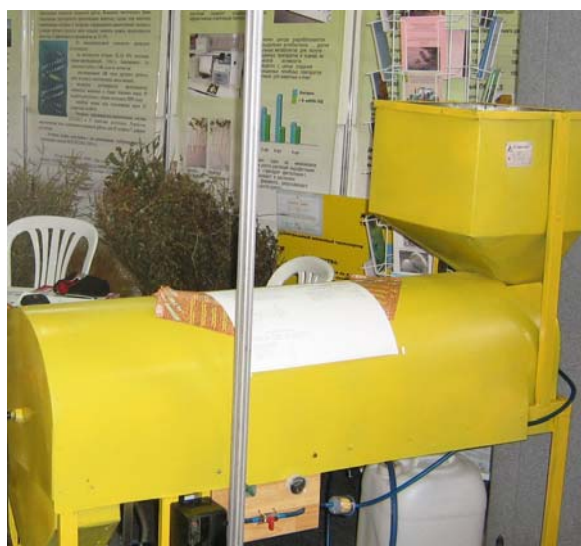
Рисунок 1.26 Протравливатель семян барабанный ПСБ-4 на специализированных выставках «Агрокомплекс» а – 2008 г., б – 2009 г.
