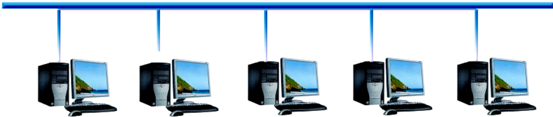
Рис. 1.6 Топология «общая шина»
