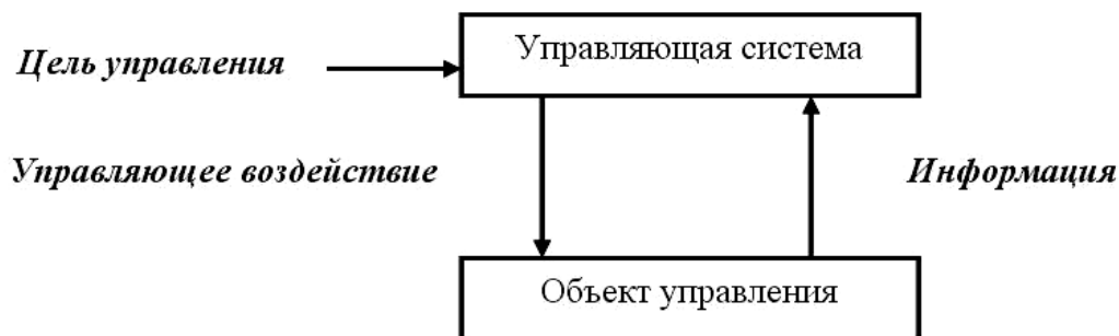
Рис. 1.1 Структура простейшей системы управления
