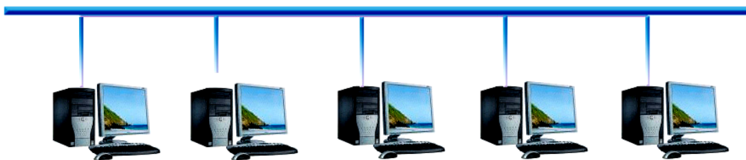
Рис. 1.6 Топология «общая шина»
