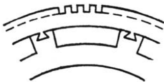
Рис. 5.10. Магнитопровод якоря машины постоянного тока большой мощности
