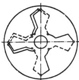
Рис. 5.92. Якорь с печатной обмоткой
