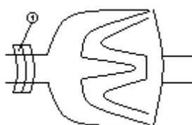
Рисунок 1.27 Синхронный генератор с когтеобразным ротором
