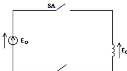
Рисунок 1.15 Упрощенная электрическая схема системы синхронный генератор – сеть.  $E_0$ - ЭДС генератора;  $E_c$  – ЭДС сети.
