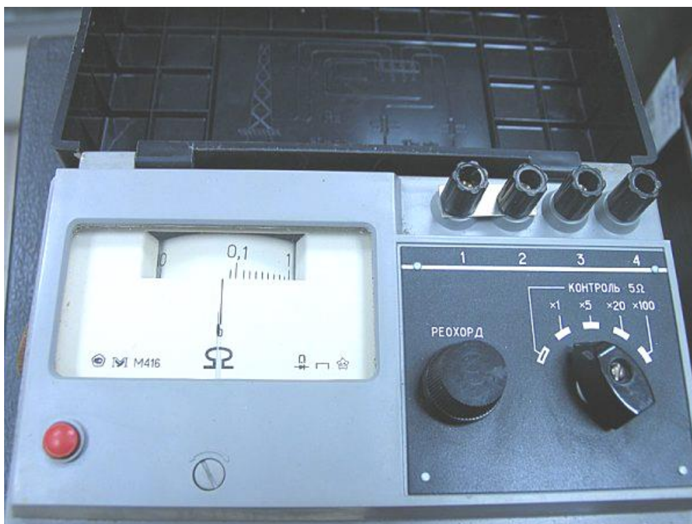
Рисунок 1 Измеритель сопротивления заземления М-416
