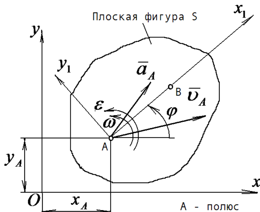
Рисунок 4.3 Движение плоской фигуры S в плоскости xOy
