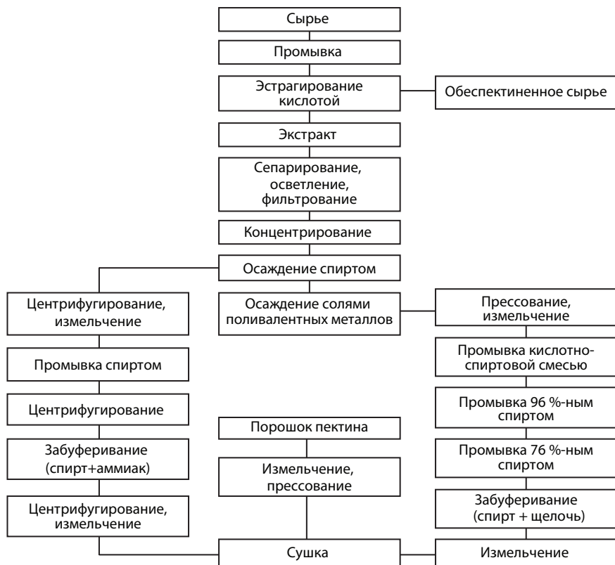
Рис. 72. Принципиальная технологическая схема производства пектина гидролизно-экстракционным способом
