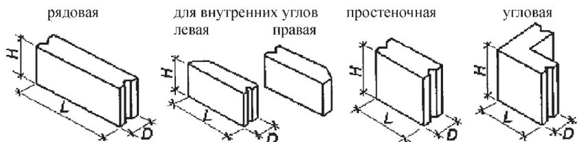
Рис. 6.49. Панели наружных стен
