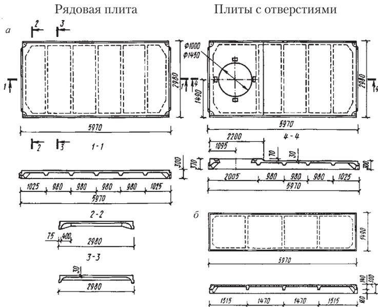
Рис. 6.11. Железобетонные ребристые плиты для покрытия производственных зданий: а – размером 6×3 м; б – размером 6×1,5 м
