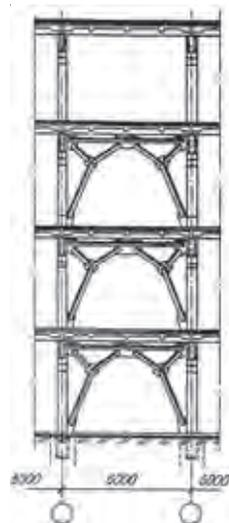
Рис. 6.37. Пример решения связей по продольному направлению разбивочных осей
