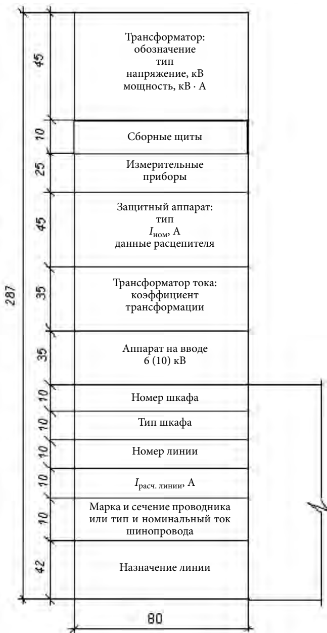
Рис. 3.8. Принципиальная схема КТП (боковик)
