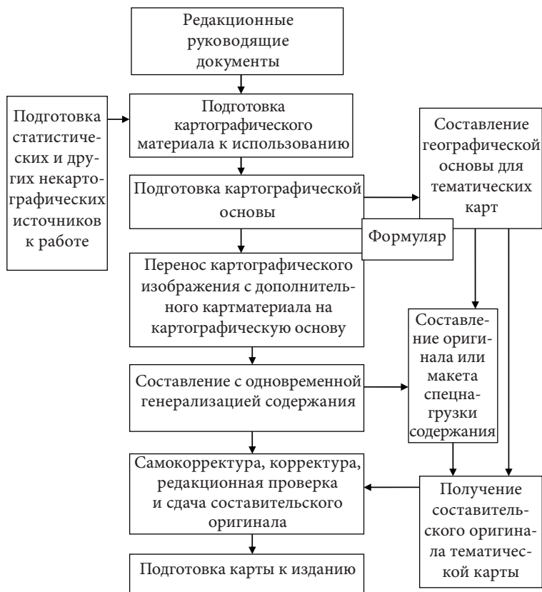
Рис. 2.4. Общая схема процесса составления оригиналов карты
