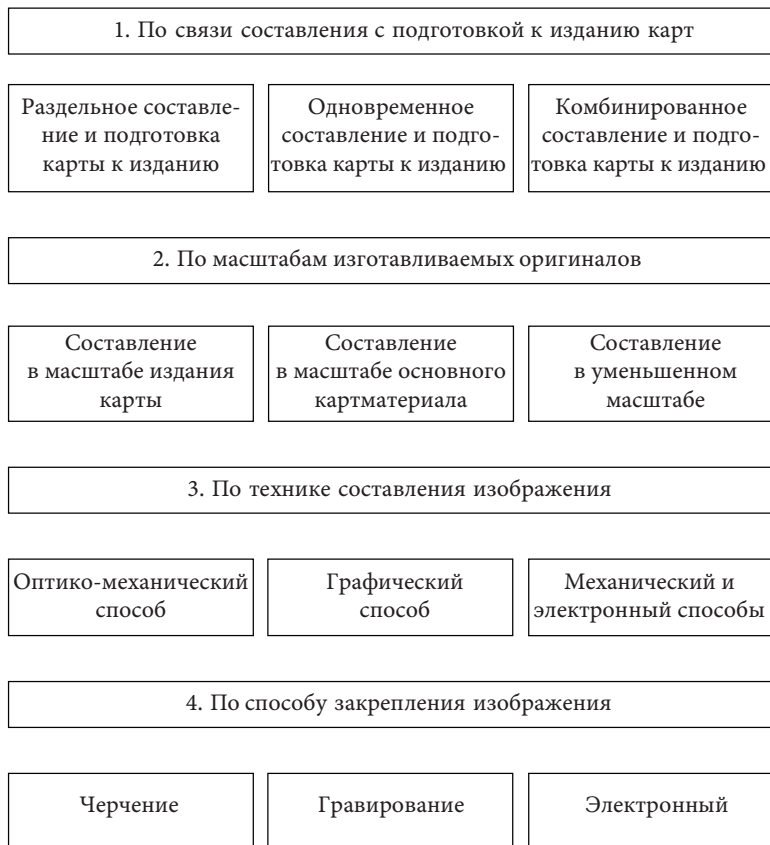
Рис. 2.5. Классификация способов составления карт
