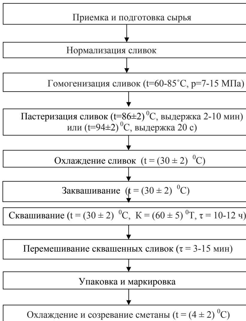
Рисунок 18 Технологическая схема производства сметаны резервуарным способом
