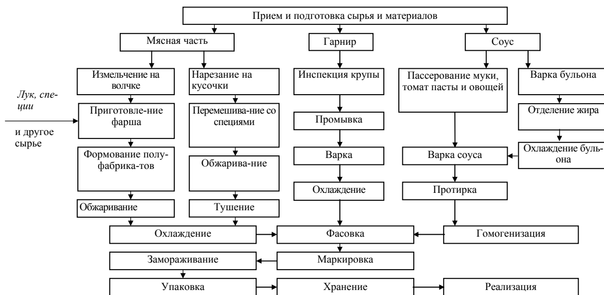
Рисунок 4.1 Технологическая схема производства вторых замороженных готовых блюд
