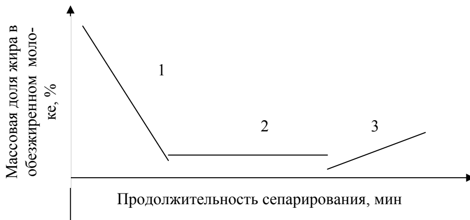
Рис. 11 Изменение содержания жира в обезжиренном молоке в процессе сепарирования
