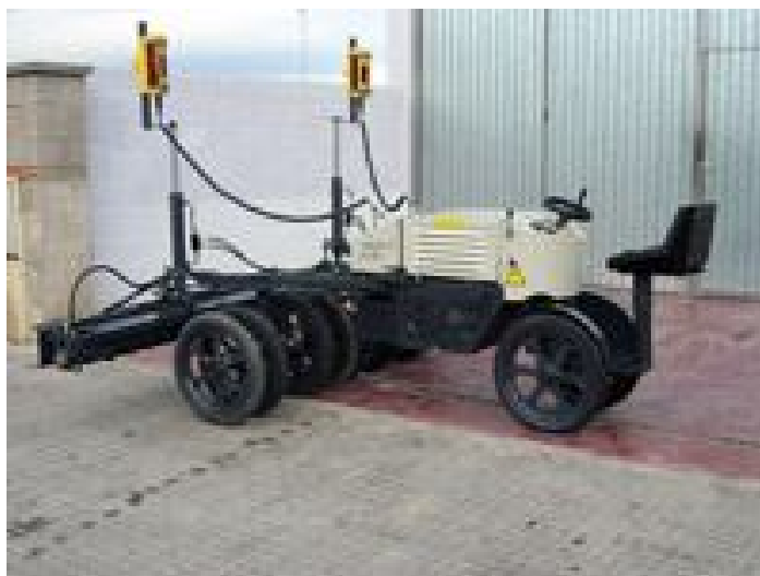
Рис. 6.8. Бетоноукладчик «Манипав» М 2000: А – габаритные размеры; Б – общий вид.
