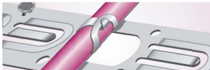
Рисунок 3.1 Закрепление кабеля на монтажной ленте
