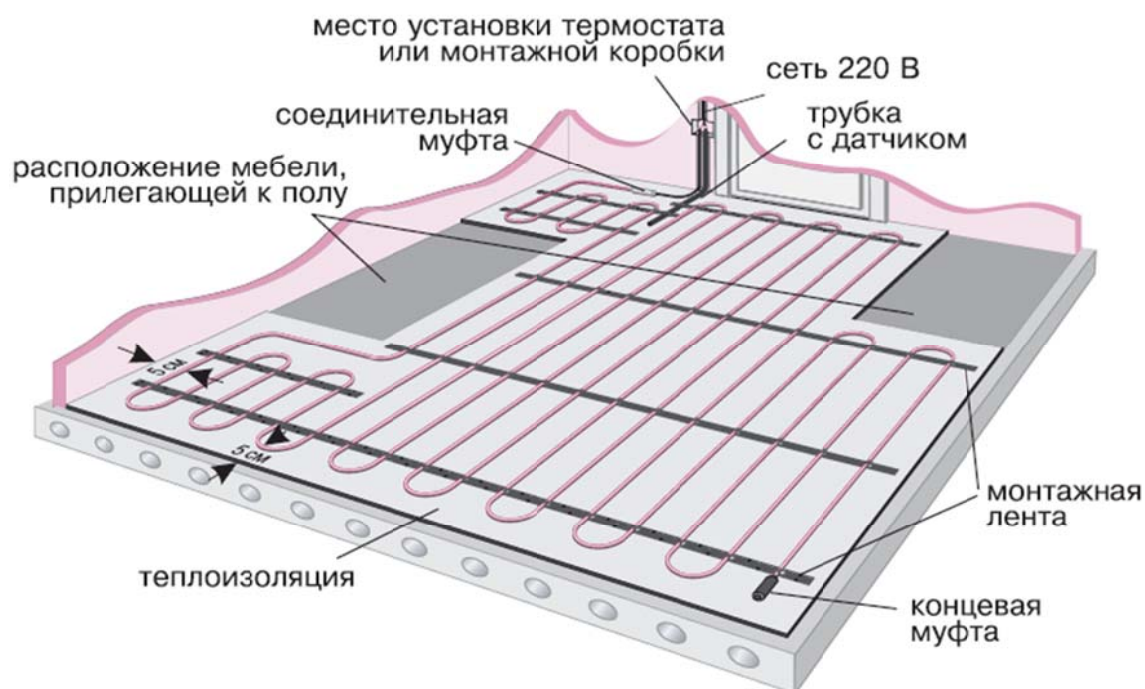
Рисунок 3.3 Система электрообогрева после монтажа
