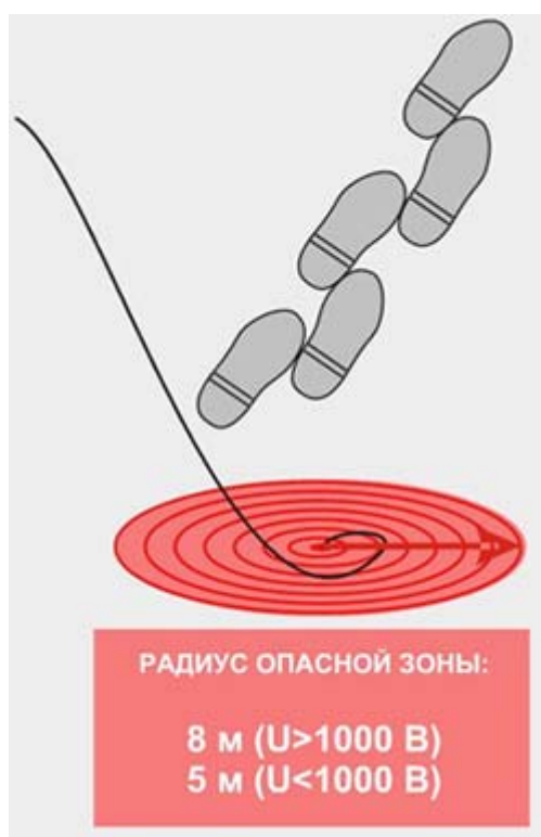
Рисунок 2.2 Радиус опасной зоны. Способ передвижения в зоне растекания тока
