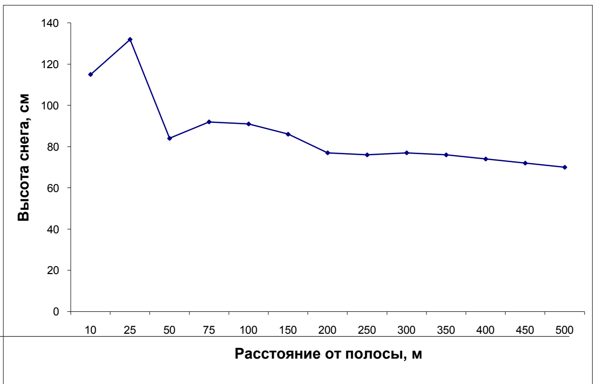
Рисунок 2.4 Профиль снегораспределения на заветренной стороне лесных полос ажурной конструкции
