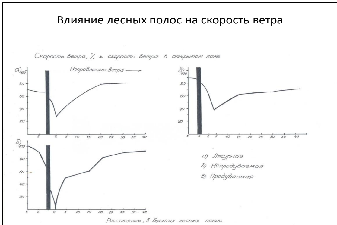
Рисунок 2.2 Влияние лесных полос различной конструкции на скорость ветра
