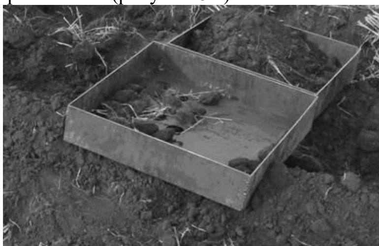
Рисунок 6.2 - Решета для просеивания почвы
