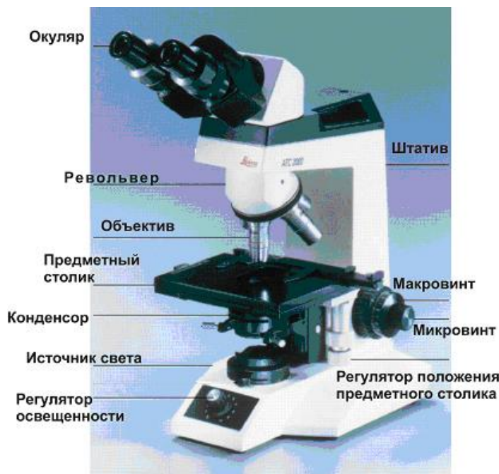
Рисунок 1 Устройство светового микроскопа
