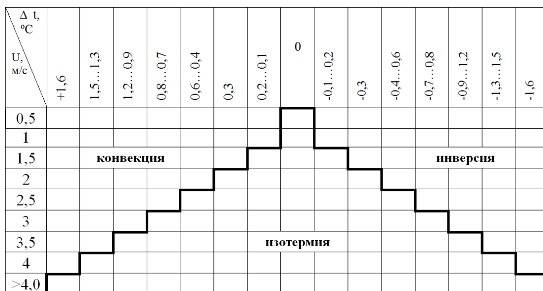
Рисунок 1.3 График для определения вертикальной устойчивости воздуха
