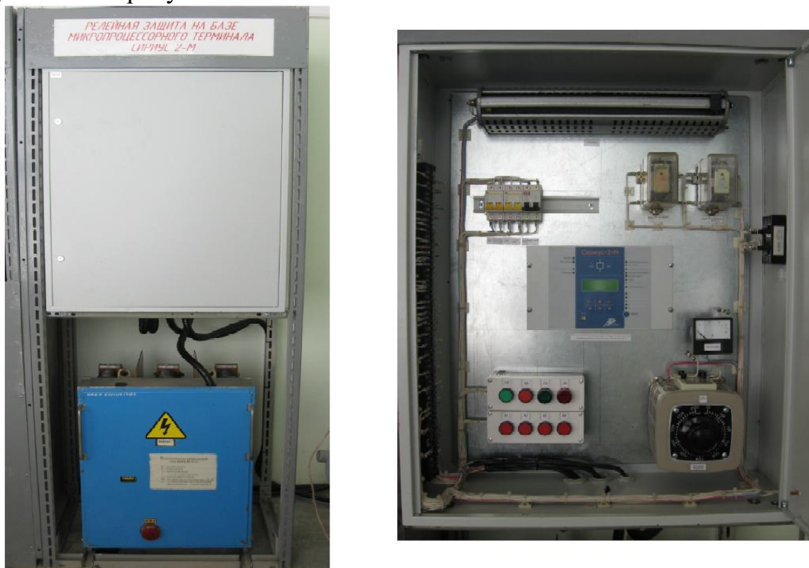
Рисунок 5.1 Общий вид лабораторной установки на базе микропроцессорного устройства «Сириус-2-М»
