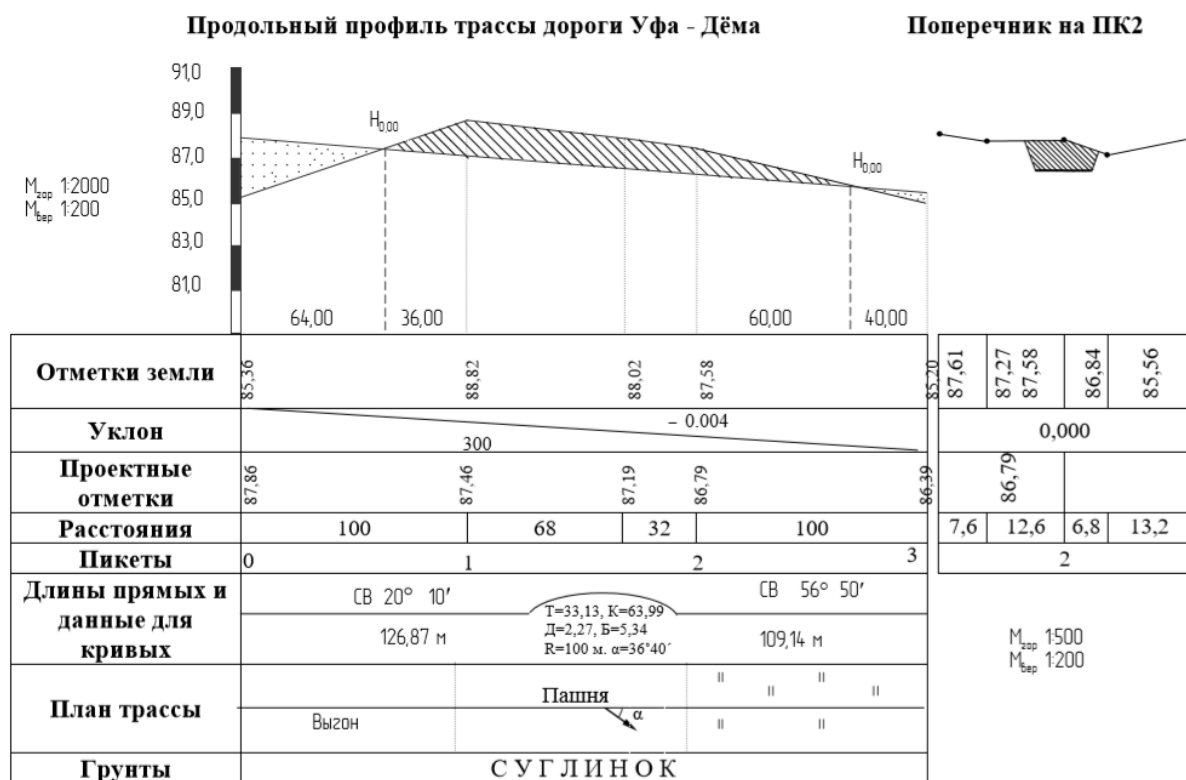
Рисунок 5 — Продольного и поперечный профиль трассы Уфа-Дема
