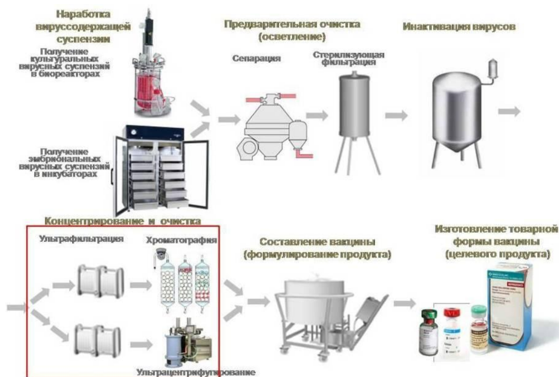
Рисунок 2 Типичный биотехнологический процесс изготовления инактивированных вакцин против вирусных инфекций
