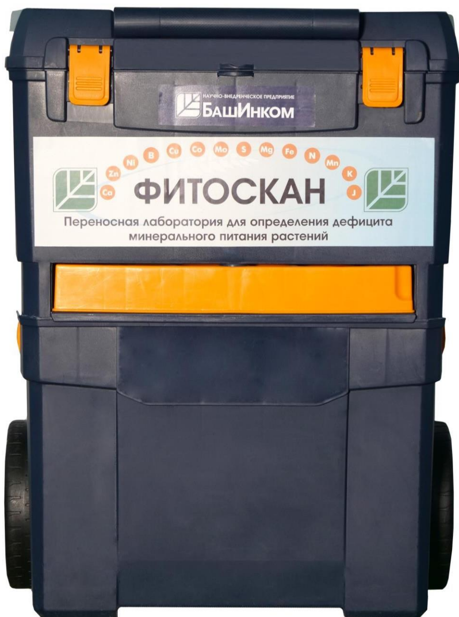
Рисунок 1. Внешний вид переносной лаборатории для определения дефицита минерального питания «ФИТОСКАН» в кейсе
