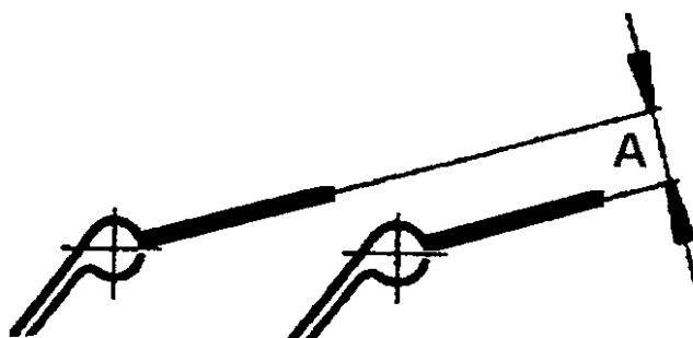
Рисунок 20 – Измерение открытия жалюзи
