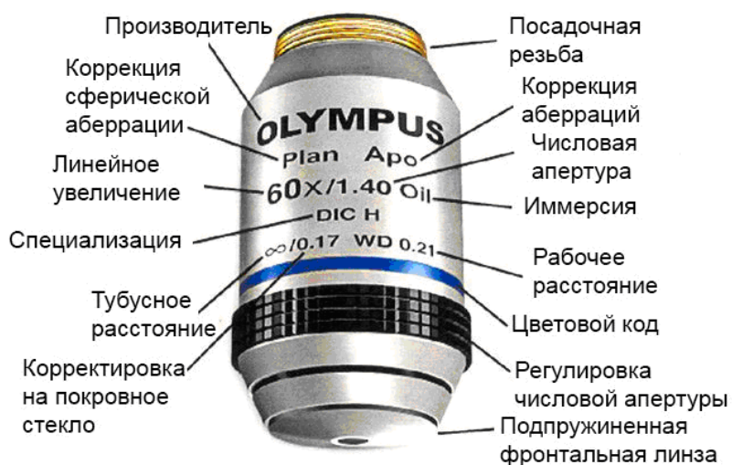
Рис. 7. Маркировка объективов
