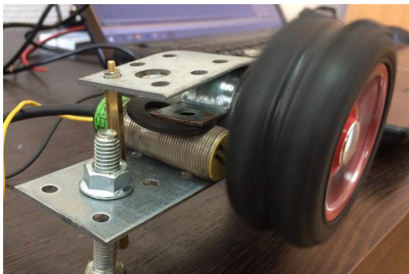
Рисунок 2 Модель колеса опрыскивателя с закрепленным индуктивным датчиком
