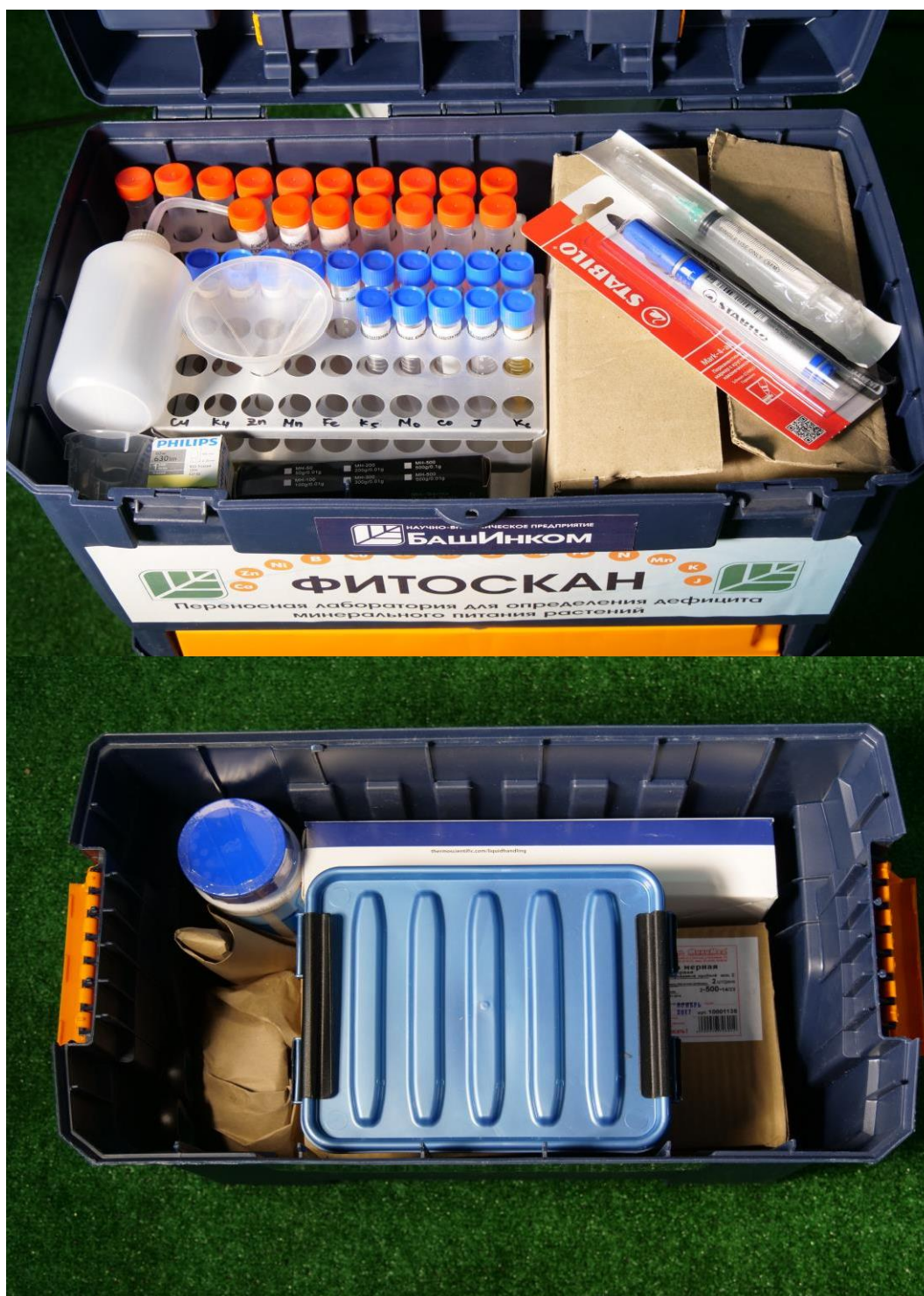
Рисунок 2. Содержание кейса с переносной лабораторией для определения дефицита минерального питания «ФИТОСКАН»
