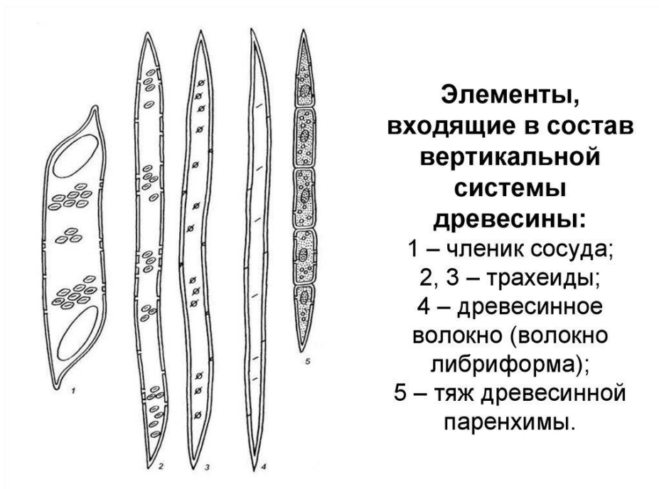
Рисунок 11 Отличия сосудов, трахеид, древесинных волокон ксилемы.
