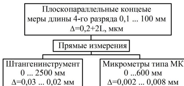
Рисунок 7.1 - Локальная поверочная схема для средств измерения длины: \Delta - погрешность средства измерений; L- числовое значение длины, м.
