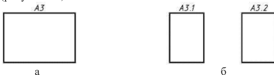
Рисунок 6.1 Способы изображения устройств на схеме: а - совмещенный способ; б – разнесенный способ
